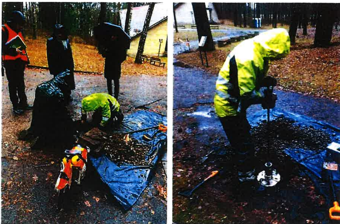
1 pav. Lauko darbai Panerių memorialiniame parke. Kairėje – kasinio K-2 parengimas, dešinėje – bandymas dinamine plokšte kasinyje K-3.
